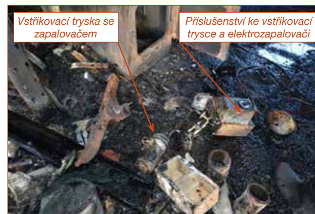
Obr. č. 4 – Detail nalezených zbytků vstříkovací trysky a příslušenství.
