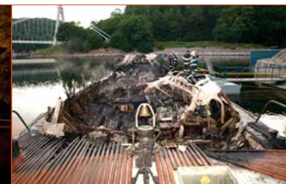
Obr. č. 5 – Pohled do prostoru lodi, kde vznikl požár.
