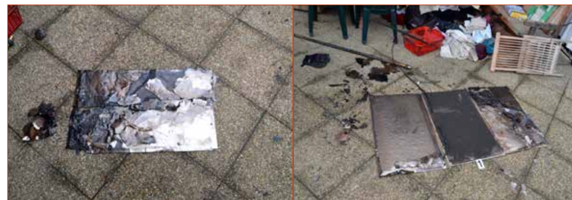
Obr. č. 5 a 6 – Pohled na infrapanely NOMATERM, 220 V, 50 Hz, 380 W, tloušťky asi 3 mm.
