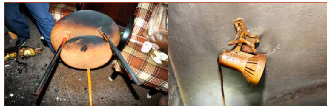
Obr. č. 2 – Stopy na stolku, které jsou charakteristické pro tepelné působení požáru ve směru od podlahy nahoru.
