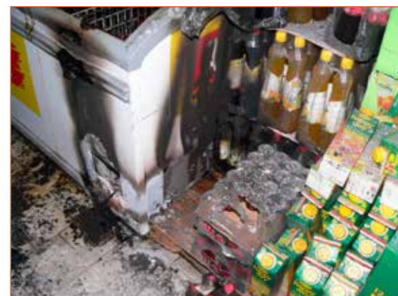
Obr. č. 5 a 6 – Detailní pohled na požárem poškozenou motorovou jednotku chladicích van.
