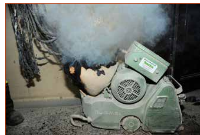
Obr. č. 2 – Pohled na zasaženou brusku.
