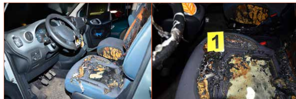
Obr. č. 3 – Pohled na místo vzniku požáru.
