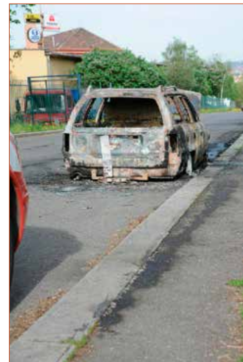
Obr. č. 1 – Pohled na zničený automobil zezadu - na chodníku zřetelná stopa po hořlavině.
