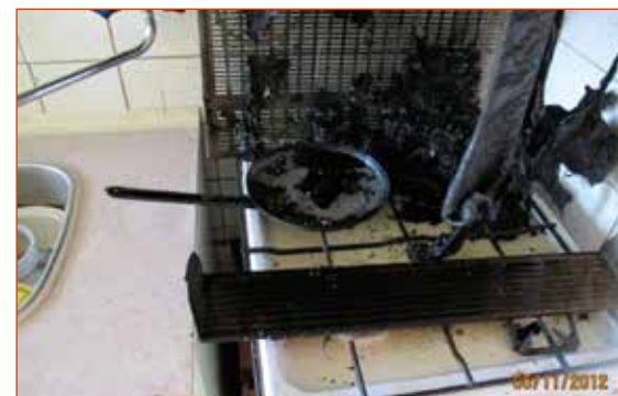
Obr. č. 3 – Detailní pohled na varnou desku kombinovaného sporáku s plynovými hořáky. Na zadním levém hořáku se nacházela pánvička, v níž došlo ke vznícení potravinářského oleje při přípravě pokrmu.
