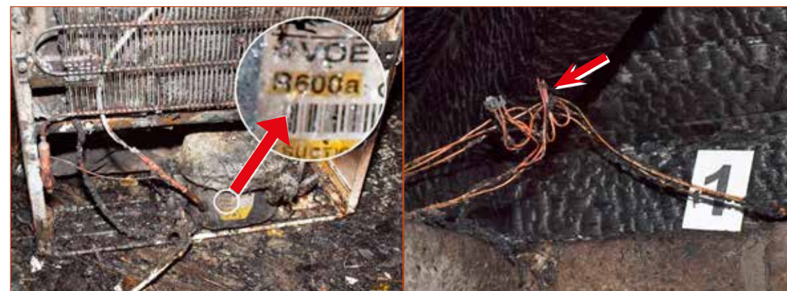
Obr. č. 5 – Zadní strana lednice s detailem označení chladicí náplně.
