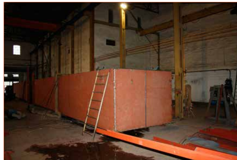
Obr. č. 1 – Celkový pohled na vyráběný ponton.
