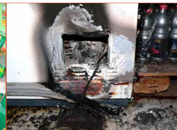
Obr. č. 5 a 6 – Detailní pohled na požárem poškozenou motorovou jednotku chladicích van.
