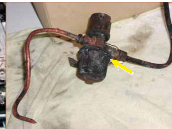
Obr. č. 3 – Pohled na nedotažený filtr u provozního elektromagnetického ventilu na LPG (žlutá šipka).
