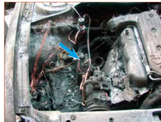
Obr. č. 2 – Pohled na motorový prostor vozidla s provozním elektromagnetickým ventilem automobilu (modrá šipka).
