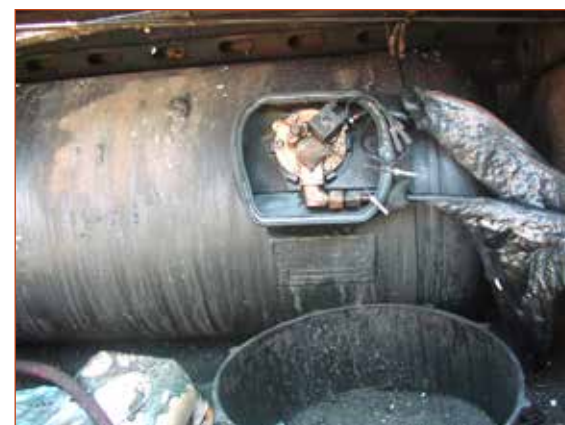
Obr. č. 4 – Snímek na multiventil na nádrži LPG.
