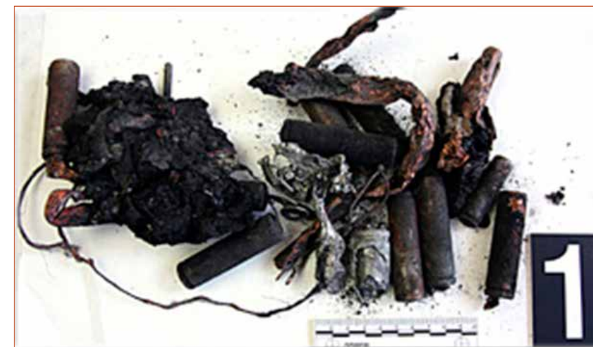
Obr. č. 5 – Kompletní sestava fragmentů akumulátoru AKU 1.
