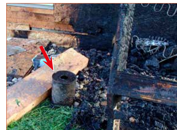
Obr. č. 5 – Plechovka od ředidla, které bylo použito jako akceleračt hoření.
