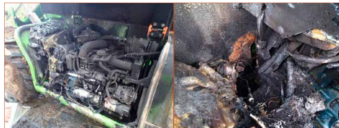
Obr. č. 3 – Motor po uhašení požáru.
