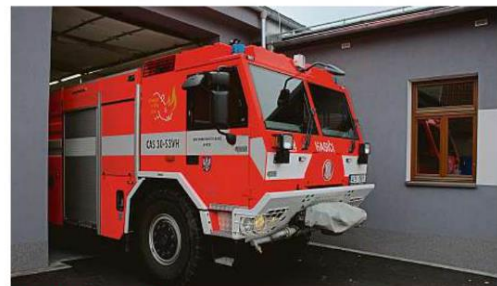
Tatra 815-7 z roku 2017 je jednou ze dvou hasičských cisternových stříkaček, které jednotka v Jevíčku používá. Vjezdě se do ní 9 kubiků vody.
